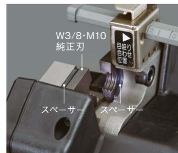
W3/8・M10切断時はスペーサーを使って刃を固定
